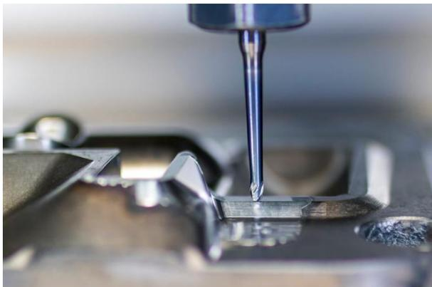
Flache Bereiche für das Gesenk werden mit dem Eckradiusfräser MAPAL OptiMill-3D-CR geschliffen, um schnell gute Oberflächen zu erzeugen. © UFT
